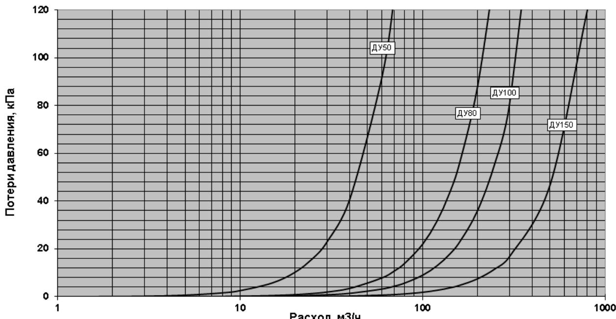
**Рисунок 2.1 – Графики потерь давления для воды**
