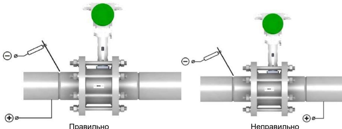
**Рисунок 2.5 – Подключение источника тока при электродуговой сварке**
