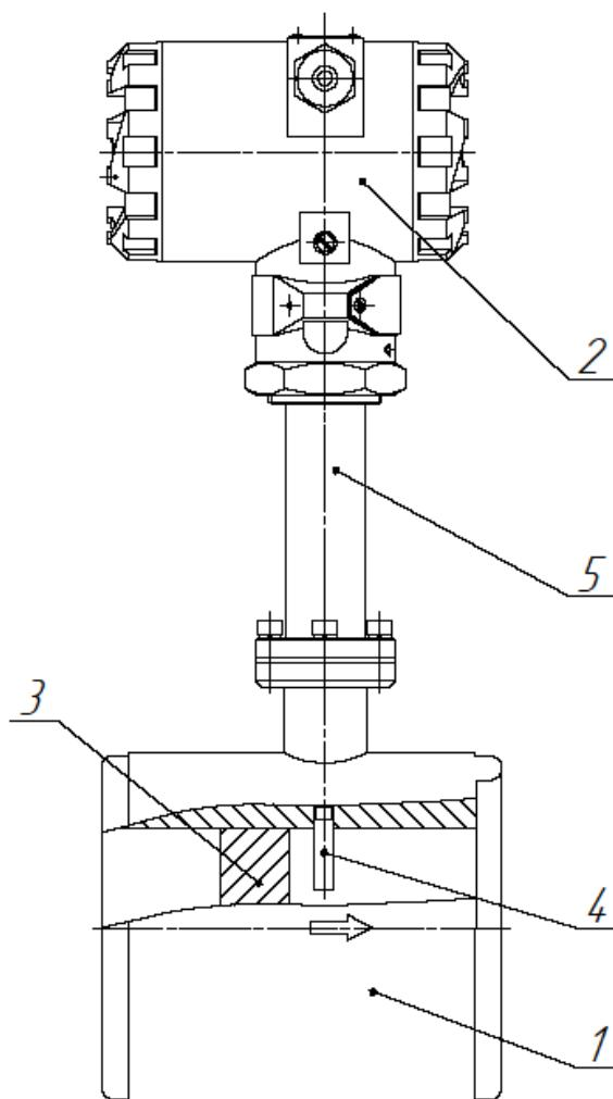
**Рисунок 1.2 – Устройство расходомера**
