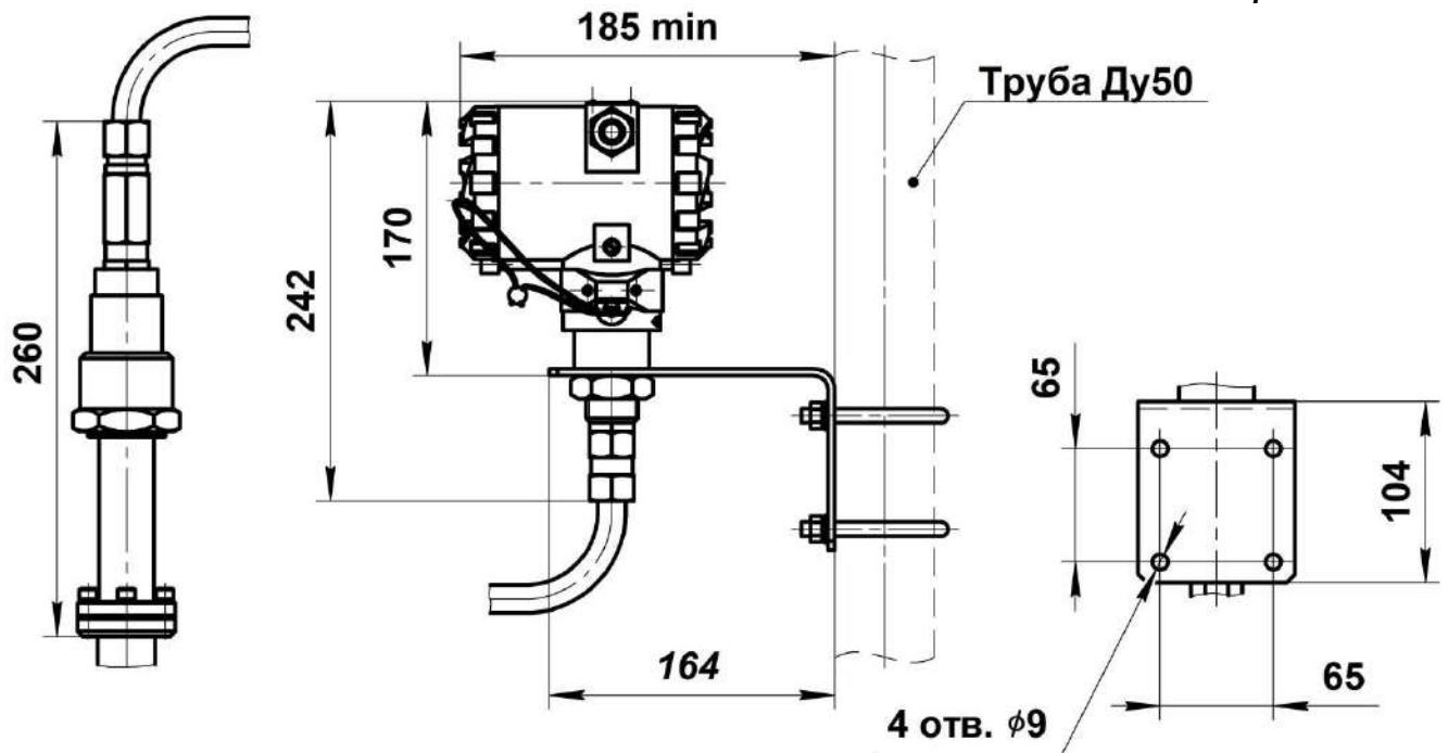
**Рисунок В.3 - Размеры расходомеров дистанционного исполнения.
