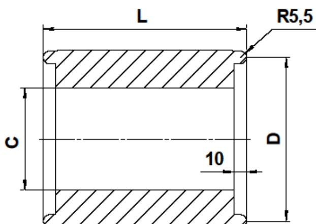
**Рисунок В.4 – Размеры монтажных вставок
